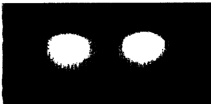
그림 11. 마크젠다 간섭기 Y-분기 근거리 패턴. Fig. 11. Near-field pattern of Mach-Zehnder interferometric waveguide Y-branch.
