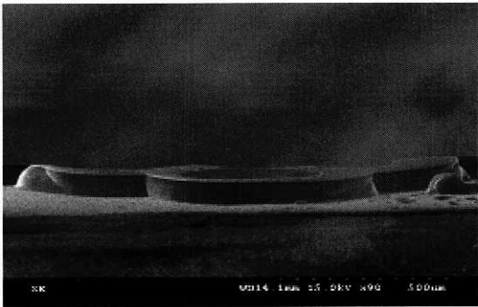
그림 6. N/O/N 멤브레인의 SEM 사진. Fig. 6. SEM picture of N/O/N membrane.
