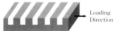
그림 2. 패드의 강성 측정개념도. Fig. 2. Schematics of measuring the stiffness ( S_H ) of pad.
