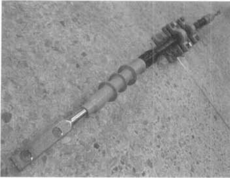
그림 3. 케이블 종단부 내전압 시험 시료. Fig. 3. Specimen for withstand test of cable terminal.
