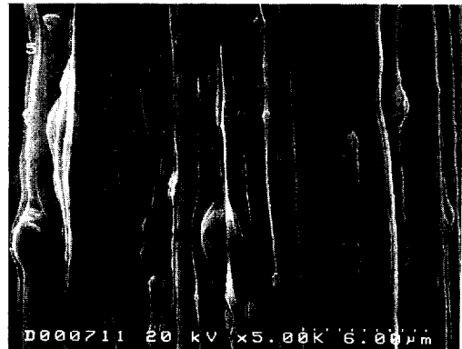
그림 11. 다심 선재중의 Nb-Ti filament의 미세조직 사진
