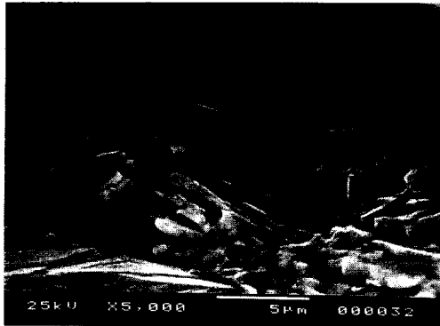
사진 1. 초전도 테이프 파단면의 SEM 사진(가압 횟수 : 3회, 초기충진압력 : 1000 kg/cm 2 )
