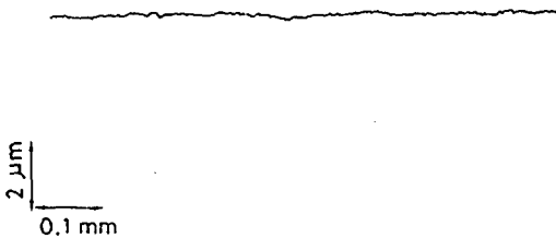
그림 9 동합금 Lead의 표면조도 Fig. 9 Behavior of surface roughness on Cu alloy lead.
