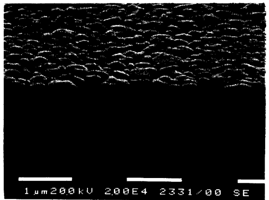
사진 1. PZT 박막의 SEM 사진 : (a) 53/47 조성의 표면, (b) 53/47 조성의 표면(고배율), (c) 53/47 조성의 단면, (d) 35/65 조성의 단면.
