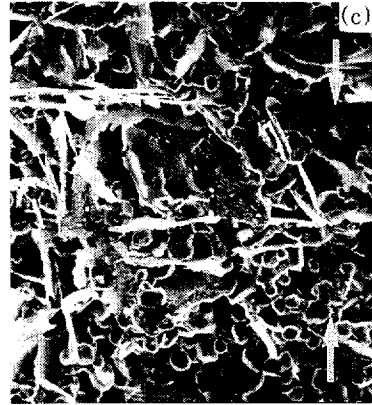
그림 9. 도포비 1 : 0.6, 소결온도 820°C에서 소결 시간에 따른 BiPbSrCaCuO계 초전도체의 SEM사진
